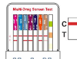
Erscheint nur eine farbige Linie in der Kontrollzone "C" und keine in der Testzone "T", ist das Testergebnis positiv. Ein positives Ergebnis bedeutet, dass die Drogenkonzentration in der Urinprobe höher ist, als der ausgewiesene Cut-off des spezifischen Drogenparameters. In unserem Beispielbild sind das die Parameter: COC/MOR
